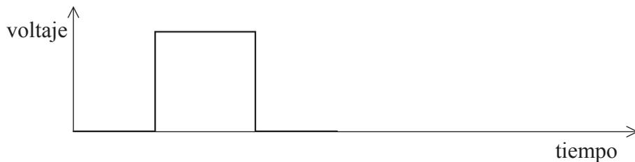
Sobre el diagrama anterior, muestre los efectos de la dispersión material sobre la señal entrante, dibujando la forma de la señal después de haber viajado una larga distancia en la fibra óptica. [1]
